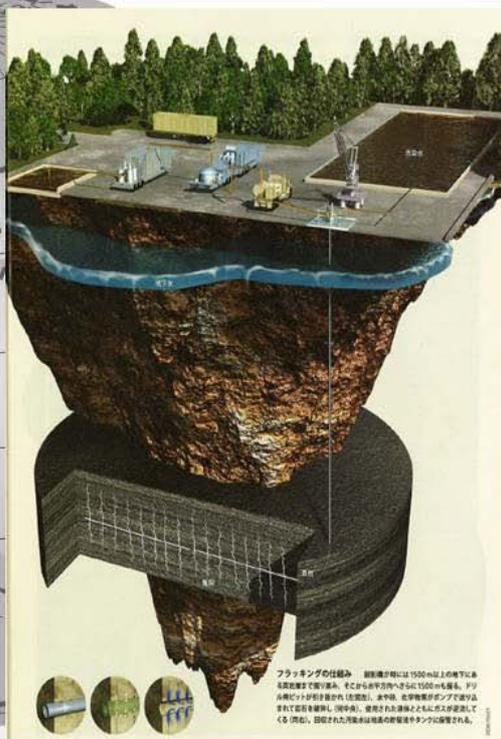
フラッキングの仕組み。掘削深度は1500m以上の地下に達する距離まで掘り進み、そこから水平方向へさらに1500mも掘る。ドリルビットが押し進められ(左図)、水や油、化学物質がポンプで送り込まれて空気を混入し(図中央)、送られた高圧の水とガスが岩石を砕いて(右図)、回収されたガスは地表面の集油システムに運ばれる。
